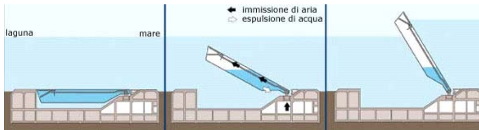
Figura 4.1 – Il funzionamento delle barriere mobili
